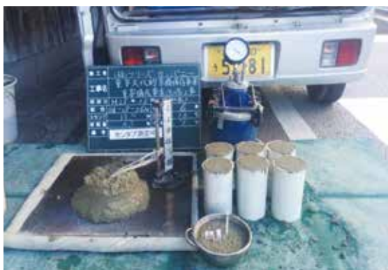
図 2-61 コンクリート工事 (強度試験)
